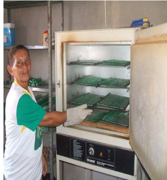
O fio é enrolado em bastidores e levado ao forno. Após 2 horas de aquecimento é inserido na água fria para sofrer choque térmico.
